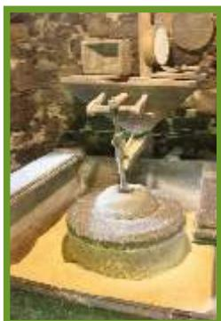
***Suxerencia:** Observación del proceso da molenda, na qu'os mecanismos s'encontran sobre a sala inferior ou inferno qu'acoye os sistemas hidráulicos inductores da rotación da mola ubicada na sala superior ou de molenda. Asina mesmo, a diferenciación dos productos lograos: farina y salvaو qu'acó se tein mezcraos.*
