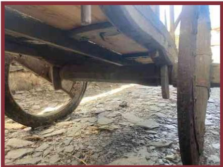
El lleto vai posto enriba del **eixe**, que ta enganchao nas **tratoiras** (úas pezas pequenas de madera) y é el que ye dá el movemento pra qu'el carro poda andar. Al eixe del carro engánchanse as dúas rodas en paralelo, que poden ser d'un ou de dous radios.
